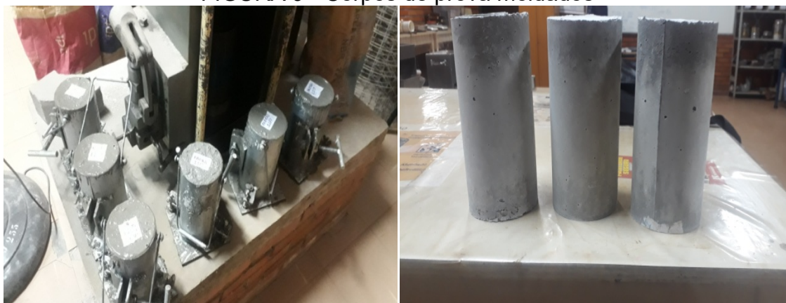
FIGURA 9 - Corpos de prova moldados
