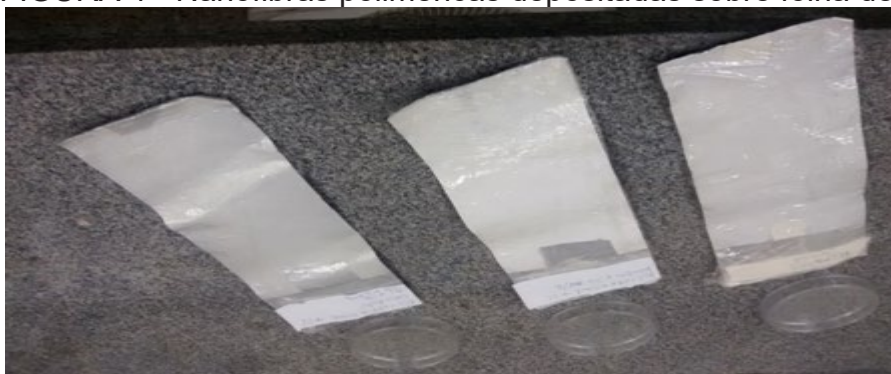
FIGURA 4 - Nanofibras poliméricas depositadas sobre folha de alumínio
