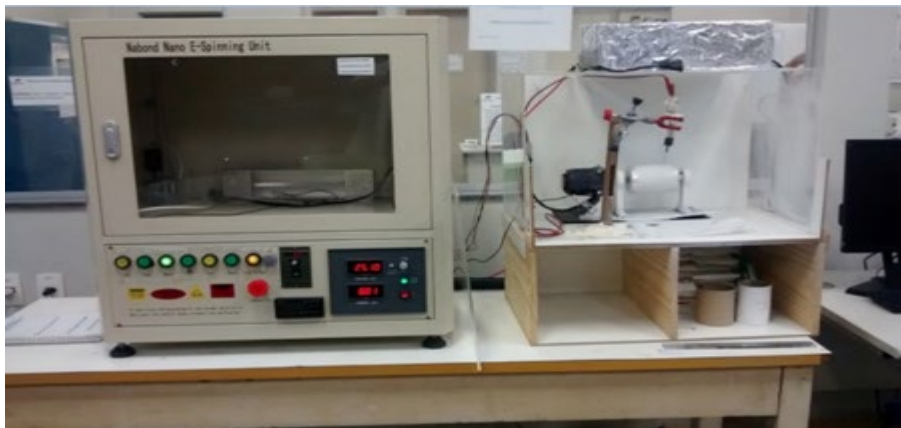
FIGURA 3 - Equipamento de electrospinning alocado no laboratório de Biomateriais do Centro Federal de Tecnologia de Minas Gerais – CEFET- MG
