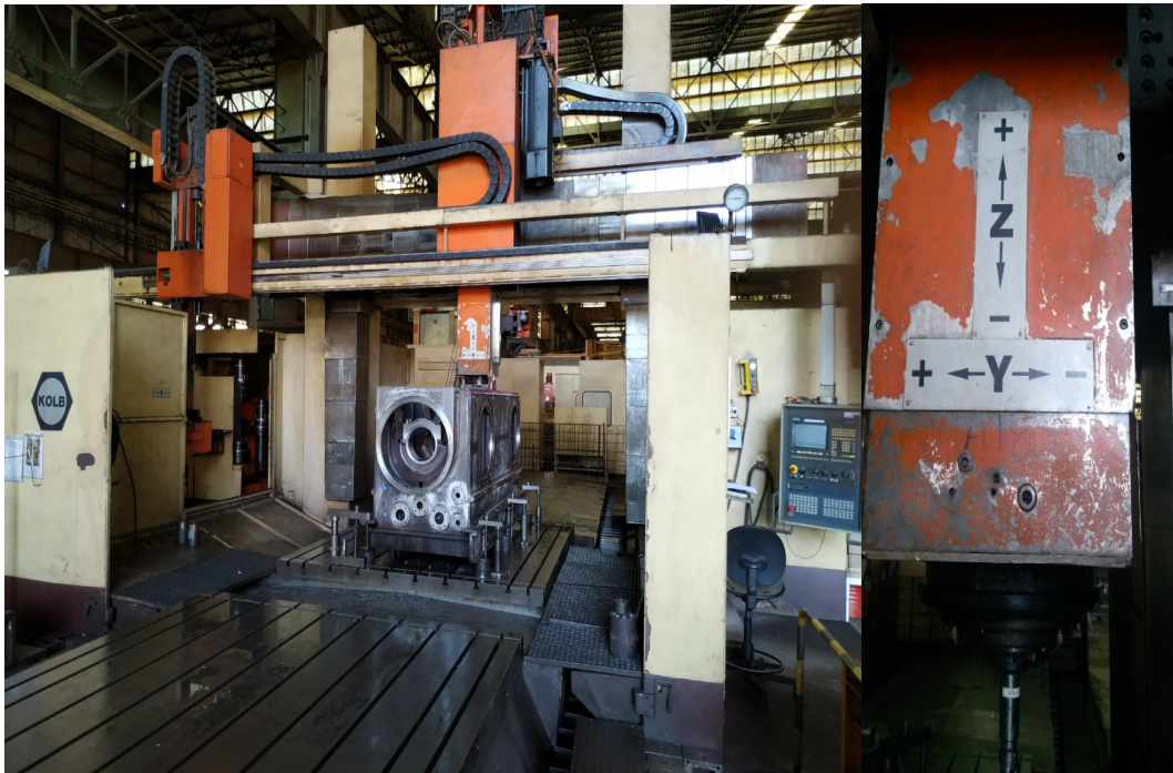
FIGURA 10 – Eixo Z da Mandriladora.
