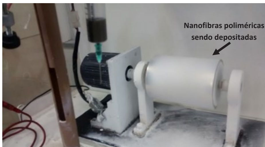
FIGURA 5 - Rolo coletor de nanofibras em uso evidenciando deposição de nanofibras
