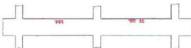
Figura 07 – Fissuras geradas por esmagamento.
