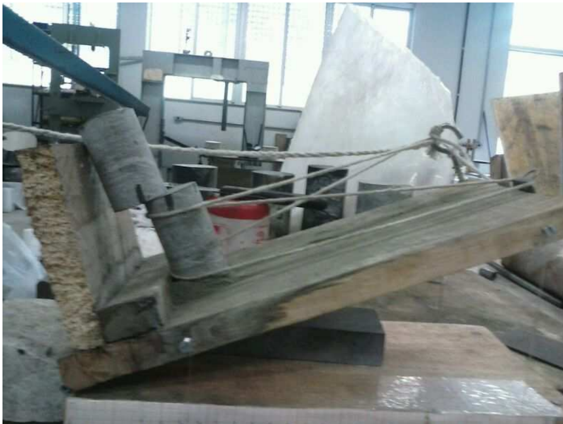
Figura 3 – Ensaio de Tilt Teste – Foto do laboratório de tecnologia de rochas da UFMG
