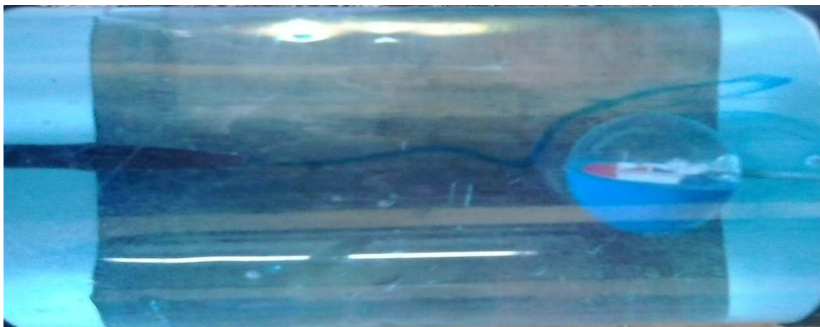
Figura -2- Demonstração da trajetória do fluído contornando a esfera
